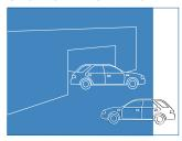
Déclenchement d'un événement dès que la limite sélectionnée pour le nombre d'objets présents dans la zone d'intérêt est atteinte. L'objet peut apparaître comme se trouvant dans une zone d'intérêt ou comme pénétrant dans une zone d'intérêt.
