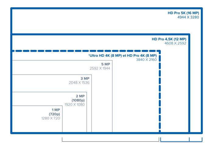
†Caméras H4, †Caméras H4 Bullet, †Caméras Dome H4, Caméras Micro Dome HD et Caméras PTZ HD Caméras HD Pro Avigilon 4K (8 MP), 4,5K (12 MP) et 5K (16 MP)
